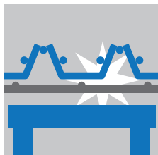
■ トラスとデッキ溶接
